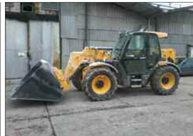
1. ábra Markoló kanállal ellátott teleszkópos szakaszos anyagmozgató a tároló feltöltésére és ürítésére. (Forrás: saját felvétel)
