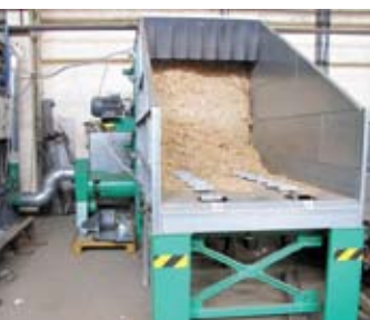
Három hengeres aprító, darabos anyag leválasztó, pneumatikus szállító, vezérlő egység
