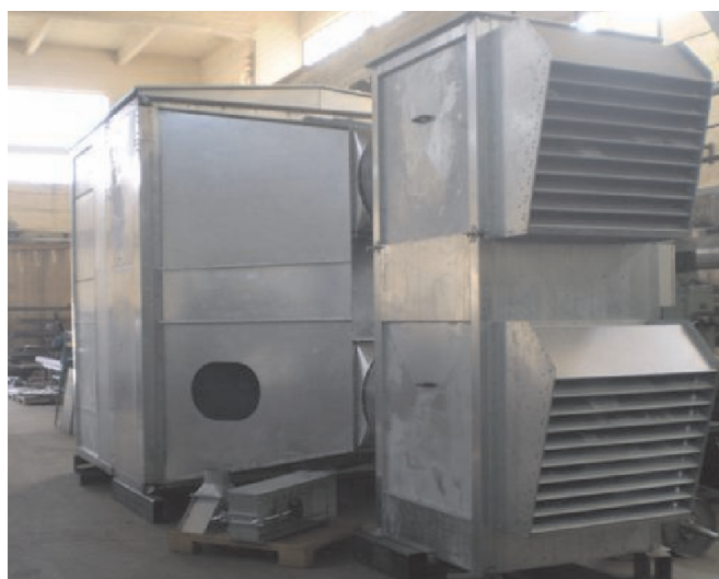
A teljes hőlég biztosító egység összeszerelve az üzemcsarnokban
