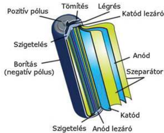
3. ábra Lítium alapú akkumulátor felépítése
