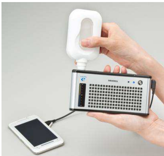
49. ábra Üzemanyagcella „feltöltése” metilalkohollal”
