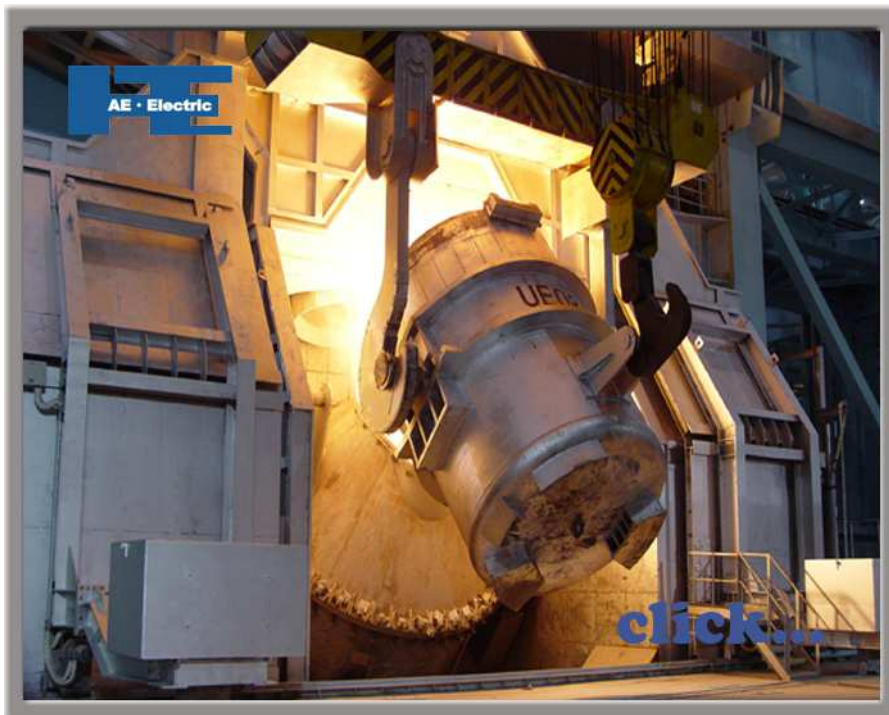
8. ábra. Argon oxigén befúvású szénmentesítő konverter http://www.tradekorea.com/product-detail/P00300110/AOD_argon_oxygen_decarburization_.html
