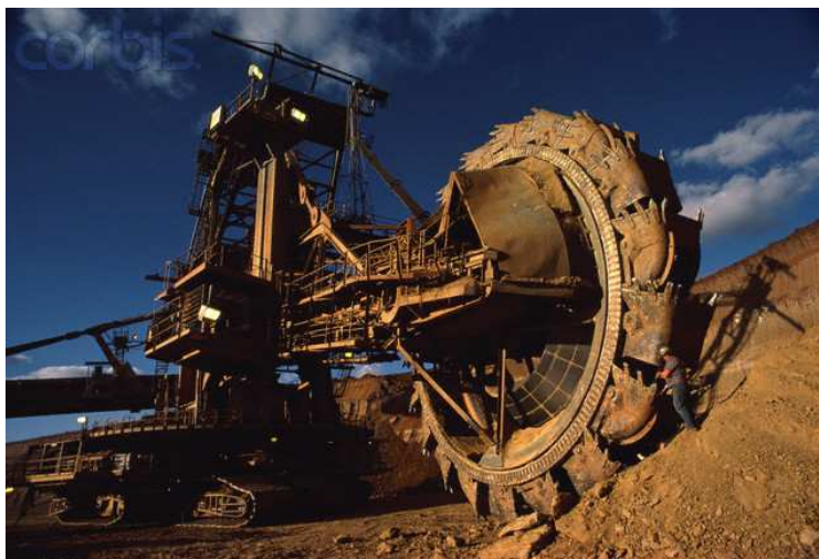
7. ábra. Vasérc külszíni fejtése marótárcsás rendszerrel
