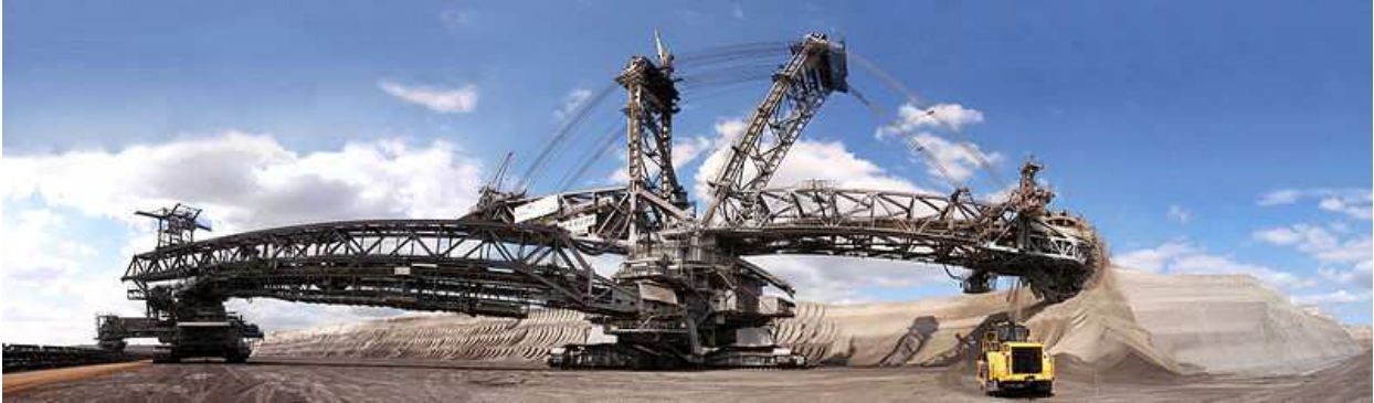
2. ábra. Marótárcsás kitermelő rendszer (típus: Bagger-garzweiler) http://flickrhivemind.net/Tags/bucketwheexcavator/Interesting
