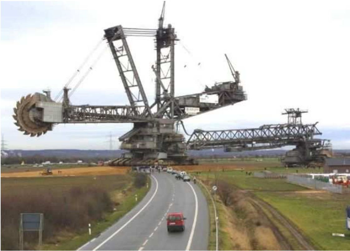
5. ábra. A külszíni fejtés legnagyobb önjáró gépe Bükkábrányban
