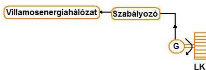
3.7. ábra. A lendkerékben tárolt energia leadása (Sembery)
