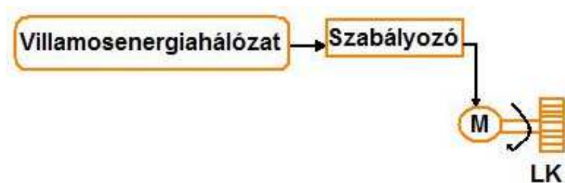
3.6. ábra. A lendkeres energiátárolás elvi vázlata (Sembery)
